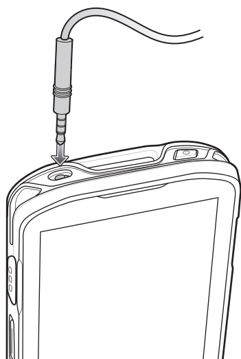
图 99 音频适配器安装
